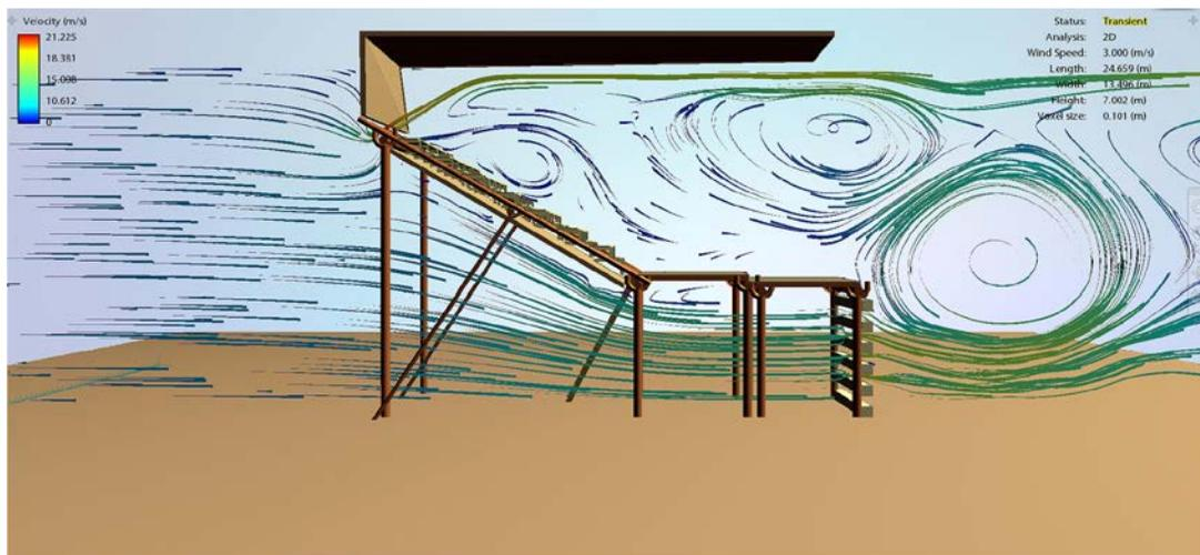
Se puede observar que la forma inclinada de la gradería favorece la entrada del aire hacia el ruedo, así como también produce un incremento del mismo. Dicho aumento llega hasta los 18 m/s, lo que representa casi seis veces la velocidad promedio en la región inmediata a la estructura dentro del ruedo.
