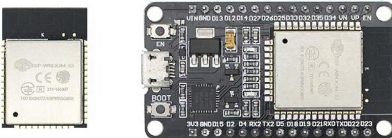
Nota: En la izquierda se muestra el módulo ESP32 y a la derecha la placa de desarrollo NodeMCU ESP-32 de 30 pines que a su vez contiene el ESP32.
